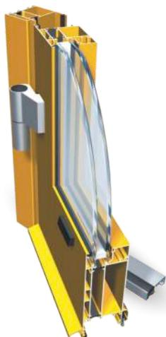
Il sistema PT 60 Ponzio si basa su una struttura del profilo a tre camere, con scanalatura per le ferramenta conforme allo standard "euro". La profondità di costruzione dei profilati per i telai fissi ammonta a 60 mm per i telai fissi ed a 68 mm per l'anta. Gli ottimi parametri di isolamento termico sono garantiti dall'inserito termico 22 mm e dalla guarnizione centrale bicomponente. Grazie all'ottimizzazione degli elementi di tenuta, non occorre utilizzare i gocciolatoi.
